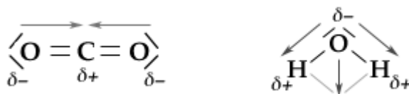
Fig. 6 - Il momento di dipolo: Confronto fra le strutture dell'anidride carbonica e dell'acqua.
