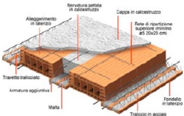
SOLAIO A TRAVETTI TRALICCIATI "BINATI"
