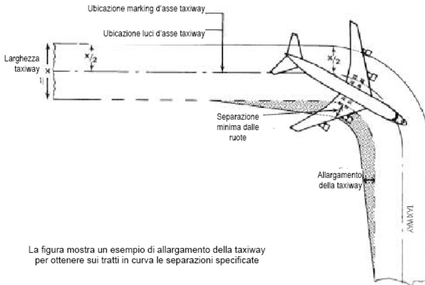
La figura mostra un esempio di allargamento della taxiway per ottenere sui tratti in curva le separazioni specificate
