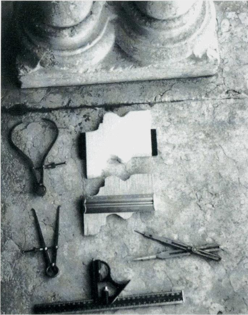
Fig. 15.3 Strumenti di rilievo: ballerine a forcipe e ad aste divaricate, profilografi ad aghi e a lame, squadra , compasso di riduzione .
