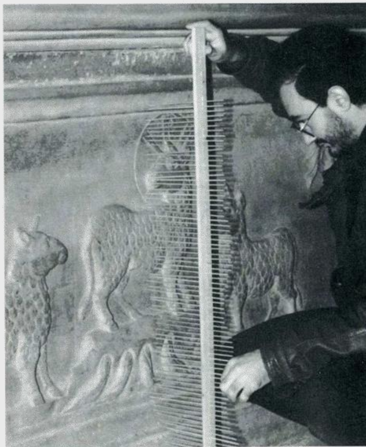
Fig. 15.5 Ravenna, Mausoleo di Galla Placidia. (Argyropoulos, Lizza e Nifosi, 1988) Rilievo in scala 1:1 dei sarcofagi del Mausoleo di Galla Placidia a mezzo di un «pettine».
