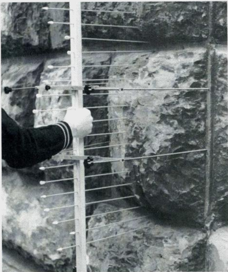
Fig. 15.4 Firenze, palazzo dello Strozzi. (Ardito, Marras, Nobile, Sermenghi e Valletto, 1988; coordinamento di P. Giovannini) Per il rilievo delle sezioni orizzontali e verticali delle bozze è stato allestito un “pettine”, di dimensione adeguata, tenuto a registro su uno spigolo regolare del muro da due distanziatori fissi.
