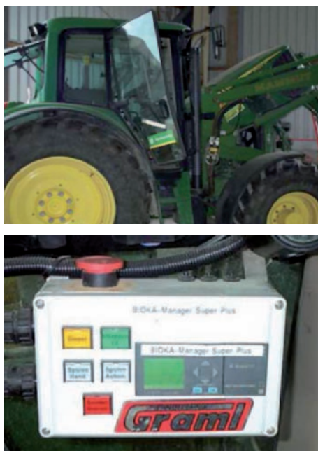
Figura 2.12 Trattore John Deere modifica- to con sistema a due serbatoi e centralina elettronica che controlla in continuo l'alimen- tazione olio vegetale/gasolio (Sistema Landtechnik GRAML)
