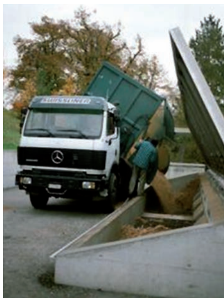
Figura 3.26 Silo per lo stoccaggio del cippato
