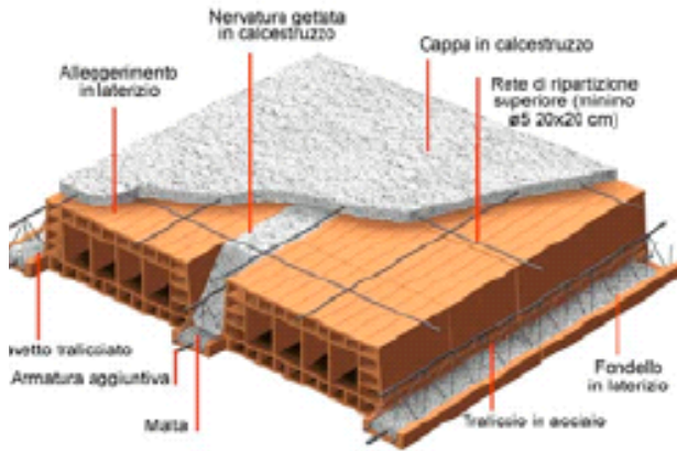
SOLAIO A TRAVETTI TRALICCIATI "BINATI"
