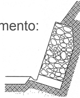
Muro di sostegno a gravità
