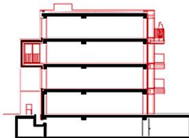
Sezione dell'edificio dopo l'intervento, in rosso le partizioni aggiunte (© Blauraum)
