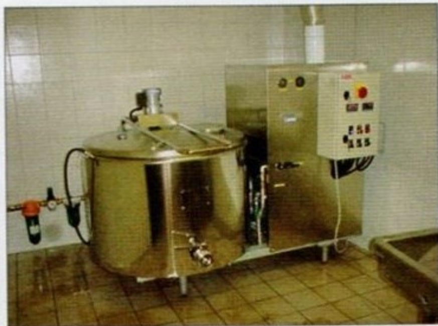
Fig. 8.12 – Impiantistica minima per un minicaseificio: una caldaietta accoppiata al gruppo energetico.
