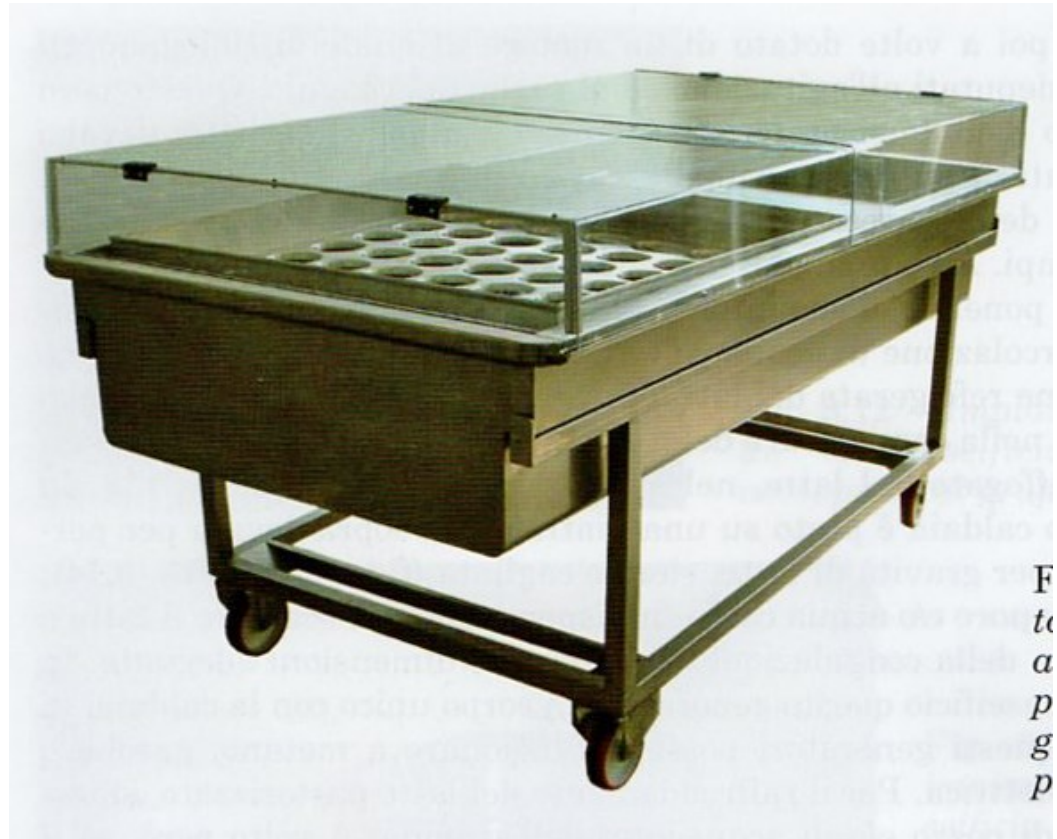
Tavolo “spersore” in acciaio inox, con coperchio, per l'alloggiamento degli stampi e la “stufatura”
